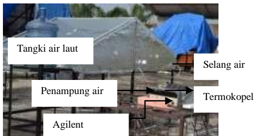
Gambar 1. Alat Desalinasi Kemiringan Ganda
